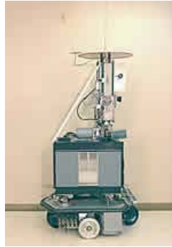
Figura 1.14: Shakey, primer robot que emplea el enfoque deliberativo para su control [Shakey-ur]
