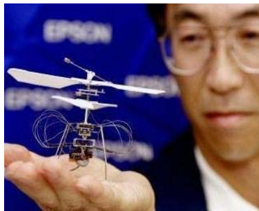
Figura 1.4: Robot aéreo iFR-II realizado por Seiko Epson, hasta el momento es el más liviano del mundo. Puede ser dirigido por control remoto a través de una computadora y lleva a bordo una cámara que puede emitir imágenes a la Tierra mediante un sistema inalámbrico. Se encuentra aún en desarrollo y por el momento su tiempo de vuelo es de 3 minutos [Robot_aereo-url]
