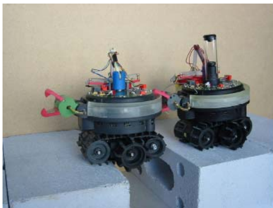
Figura 3.6: Se muestra una conexión fija de dos S-bots, y la cooperación entre ellos para contender con huecos en la superficie del terreno.
