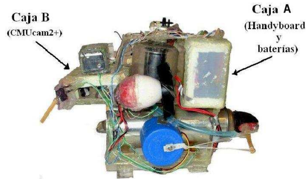
Figura 3.8: Prototipo 3: Vehículo submarino orientado a tareas, descripción de componentes 1, lado izquierdo del prototipo.
