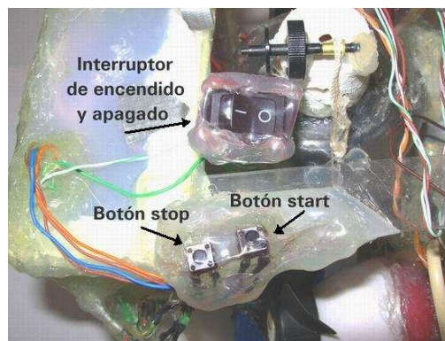
Figura 3.12: Prototipo 3: Vehículo submarino orientado a tareas, descripción de componentes 5. Extensiones de los botones de start , stop y del interruptor on/off de la Handyboard©. Las extensiones de los botones permitieron controlar a la tarjeta controladora desde el exterior de la caja que la contenía (caja A). Para evitar que les entrara el agua, se cubrieron con plástico y con un poco del pegamento empleado para pegar las cajas A y B.
