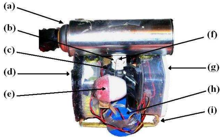
Figura 3.5: Prototipo 2 v2.0: Vista lateral derecha del vehículo submarino básico. (a) Tanque de aire comprimido, (b) Posición de la válvula, la válvula se encuentra protegida para limitar su rango, (c) Campana, (d) Caja B (contiene las baterías y arena), (e) Motor DC a prueba de agua, (f) Hilo que conecta al servo-motor uno con la válvula, sirve para abrir la válvula, (g) Caja A (contiene a la Handyboard©), (h) Servo-motor uno a prueba de agua y (i) Base del prototipo.
