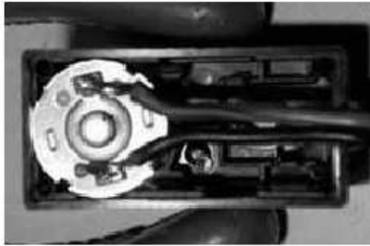
Figura D.2: Servomotor modificado. Vista interna.
