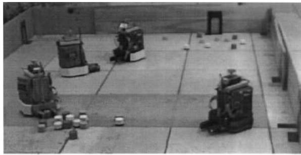
Figura 3.4: Búsqueda y recolección de objetos empleando un sistema multi-robot. El objetivo de la tarea es recolectar el mayor número de objetos y colocarlos en una zona del ambiente conocida como “hogar”, en la esquina superior derecha de la imagen. Tomado de Matarić (1997).
