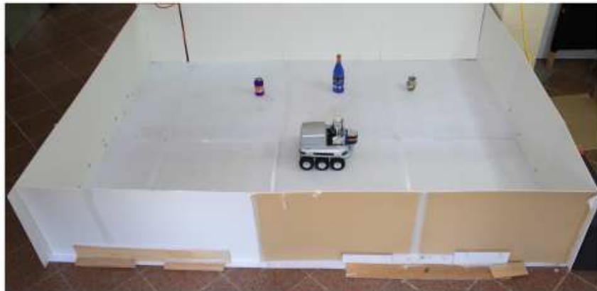
Figura 4.1: Ambiente del sistema multi-robot. Se presentan tres objetos distintos colocados en línea recta separados por una distancia uniforme.
