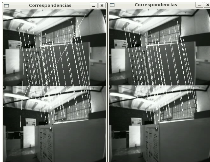
(a) Correspondencias erróneas eliminadas mediante RANSAC.
