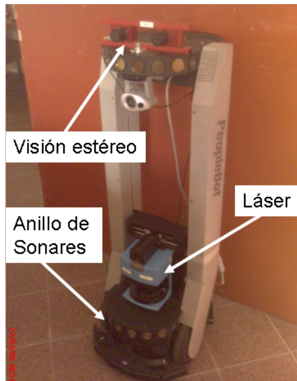
Figura 5.2: Robot móvil PeopleBot dotado de un sistema de visión estéreo, un anillo de sonares y un sensor láser utilizando en la experimentación.
