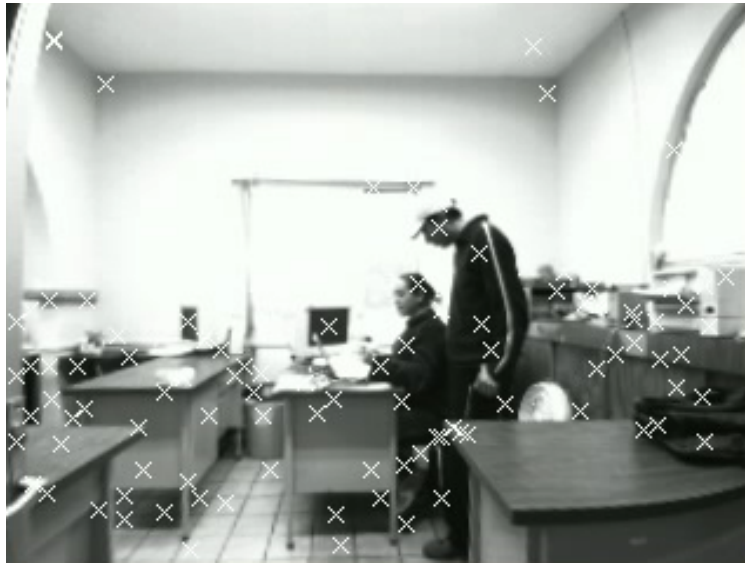
(a) Imagen captura por la cámara y marcas visuales detectadas.
