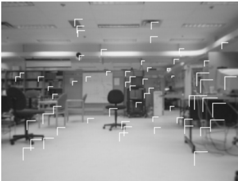
Figura 2.4: Conjunto final de marcas SIFT detectados en [7]. Después de hallar la relación entre conjuntos de SIFTs de cada imagen, las líneas horizontal y vertical representan la disparidad horizontal y vertical [7].
